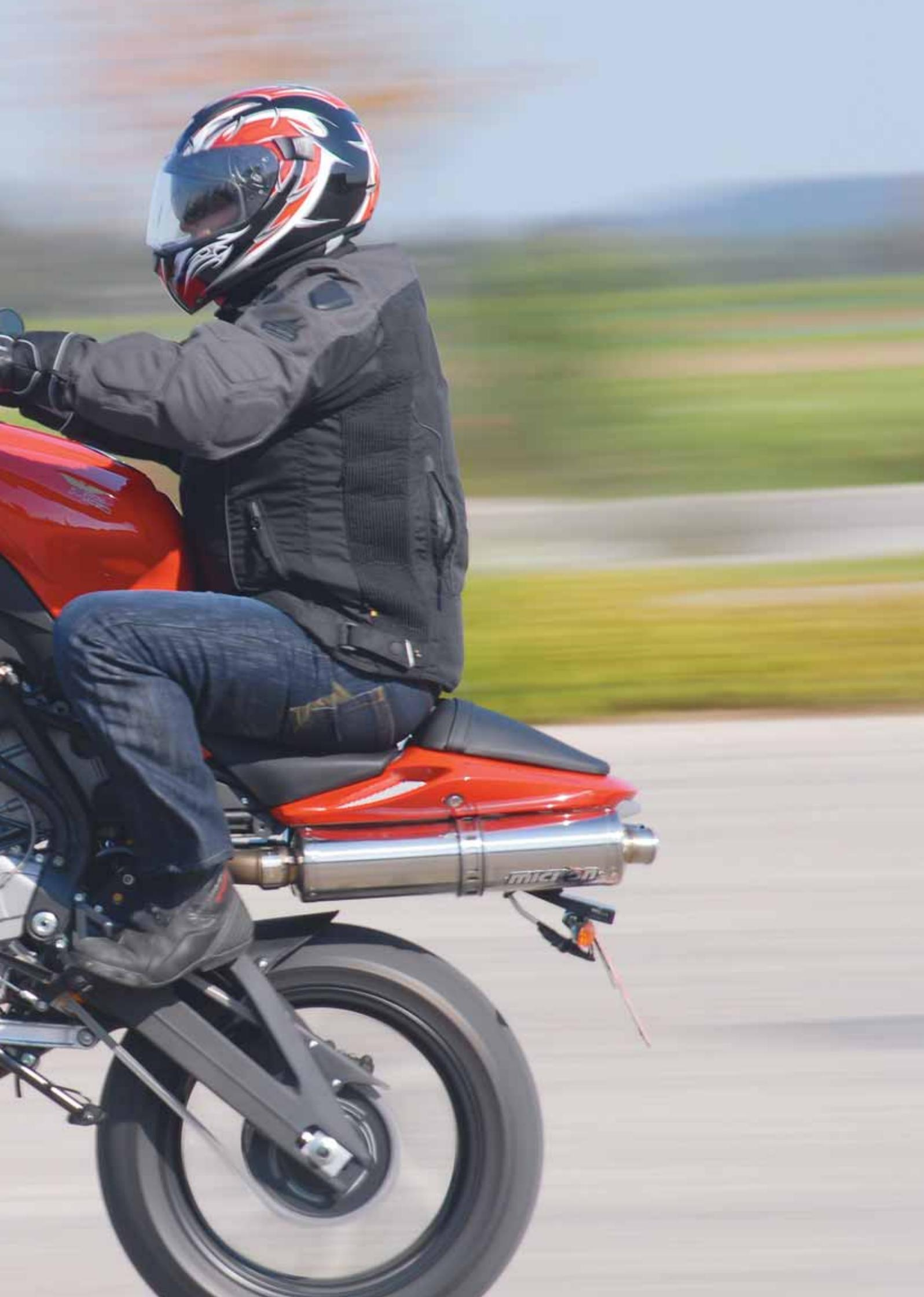
Superbike-Prügellenker ist sportlich versammelt, die Fußrasten hochwassertauglich, dafür der Abstand von der Sitzmulde zum Boden mit 830 mm recht weit. Ein Tribut auch an die Underseat-Doppelauspuffanlage, die in unserem Fall mit zwei Micron-Töpfen versehen war. Deren kerniger Klang ist eintragungsfähig, die leicht schielenden Auslassöffnungen zumindest ungewöhnlich.
