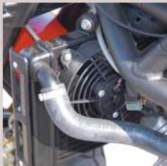
Wird im Stadtverkehr gebraucht: Elektrischer Zusatzventilator
