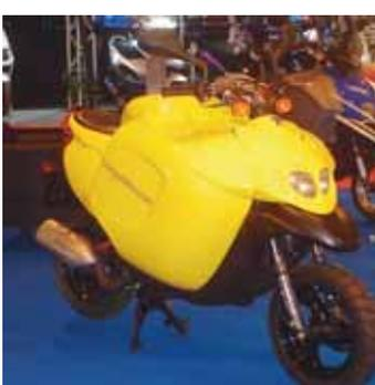
In Paris entdeckt: Umgerüsteter Peugeotroller für Lastentransporte, der Fahrer sitzt dafür auf dem Gepäckträger.
